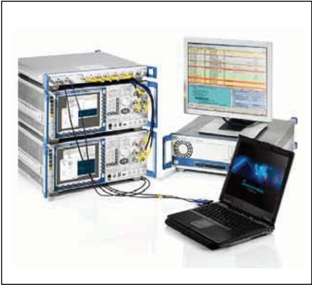
图 7. 测试采用 2 x 2MIMO 的载波聚合移动性的 Multi-CMW 设置
