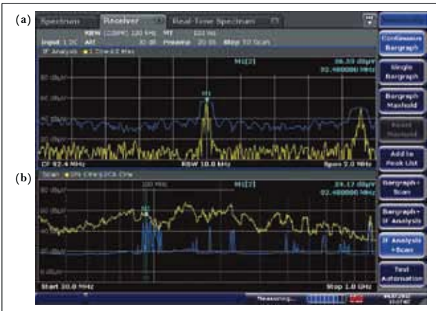
图 3. 使用分屏显示的中频分析: 在 EMI 接收频率附近的射频输入信号 (a) 和保存的预览测量轨迹 (b)
