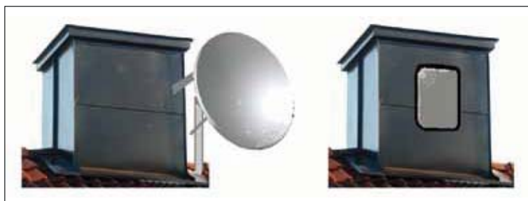
图 1. 点到点无线链路中抛物面天线和毫米波平面阵列天线。
