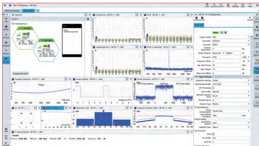
图2: 测试软件R&S CMsquares控制着所有5G无线电通信测试仪, 让5G NR测试协调一致。
