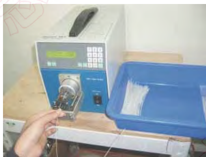
图4. CMC 半自动剥皮器可保证质量与精确和稳定的剥离公差控制, 满足从0.8mm~10mm不等的电缆组件的标准和客户的特殊要求外形尺寸。
